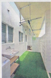
建物裏手に配したサービスヤード。トップライトや花ブロックを用いて、風や日差しを取り込めるようになっています。
